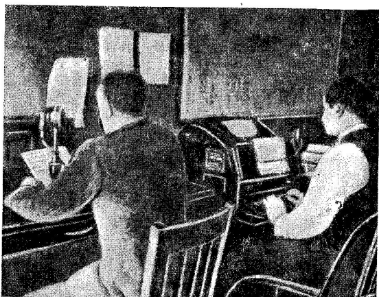
Рис. 5. Передача последних новостей из студии. Направо расположен прямо-передающий аппарат типа «Телетайп» (США)
