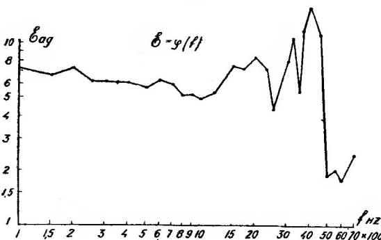
Рис. 9. Частотная характеристика адаптера
