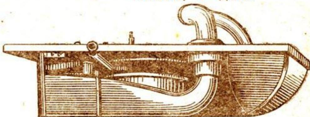
Рис. 117. Дека и укрепленные на ней: снизу рупор с механизмом, сверху тонарм
