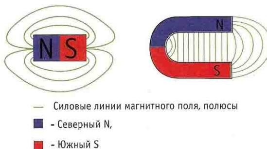
Рис. 1 Магниты и конфигурации их магнитных полей: а – прямоугольник, б – подкова
