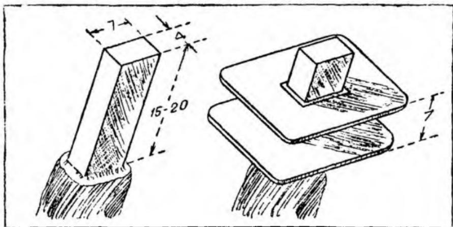
Рис. 32. Каркас катушки склеивают на болванке.
