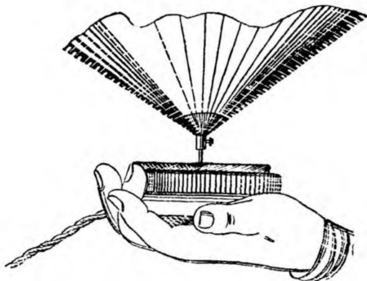
Рис. 26. Диффузорный громкоговоритель из телефонной трубки.
