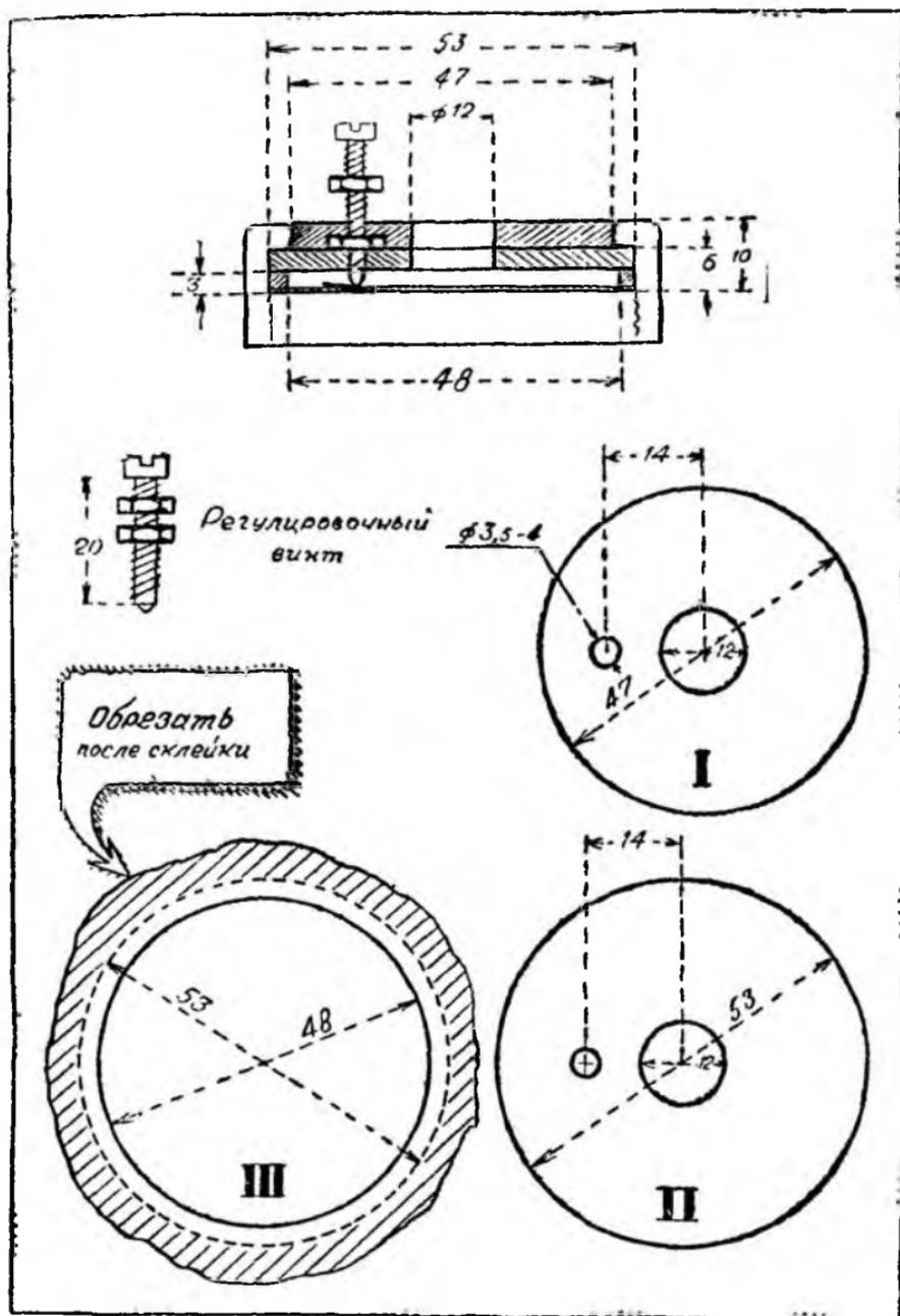
Рис. 29. Крышка громкоговорителя из телефонной трубки.
