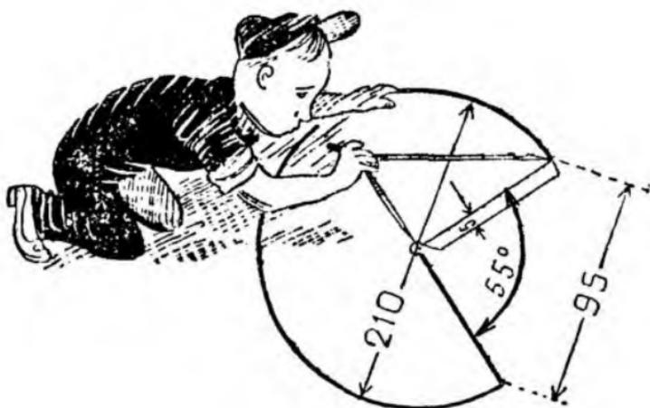
Рис. 23. Выкройка диффузора.
