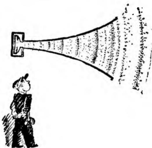
Рис. 18. Звуковые волны идут по постепенно расширяющемуся рупору.
