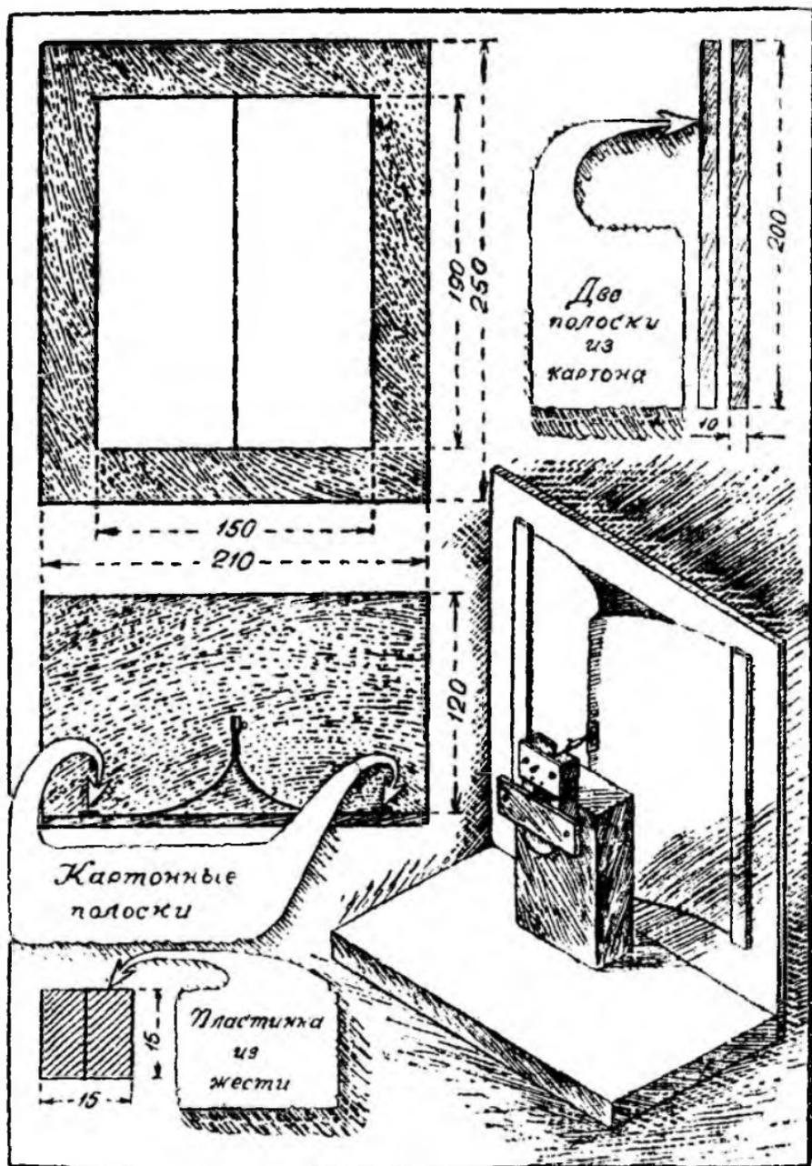
Рис. 47. Диффузор-книжка.
