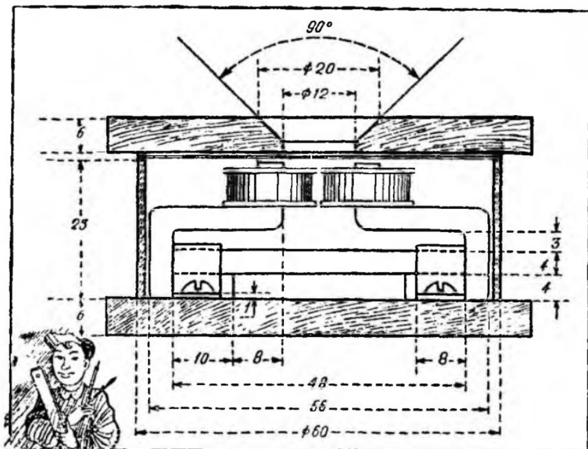
Рис. 34. Вид самодельной телефонной трубки сбоку. Корпус разрезан.
