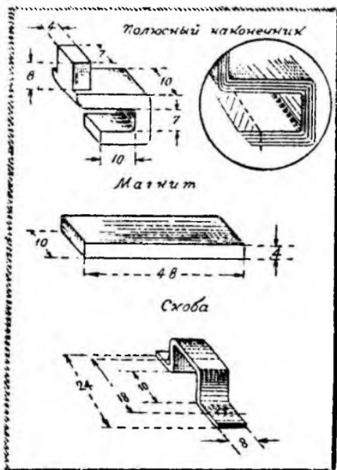
Рис. 37. Детали самодельной телефонной трубки.
