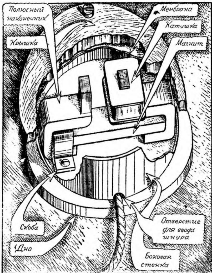
Рис. 36. Общий вид самодельной телефонной трубки.
