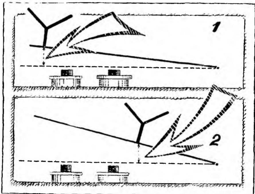
Рис. 28. Размах колебаний диффузора не должен изменяться.
