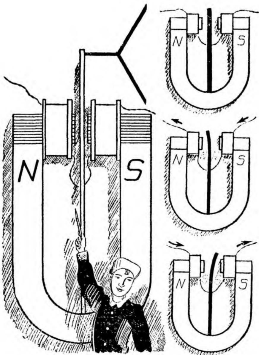
Рис. 40. Так работает громкоговоритель без постоянного магнитного притяжения.
