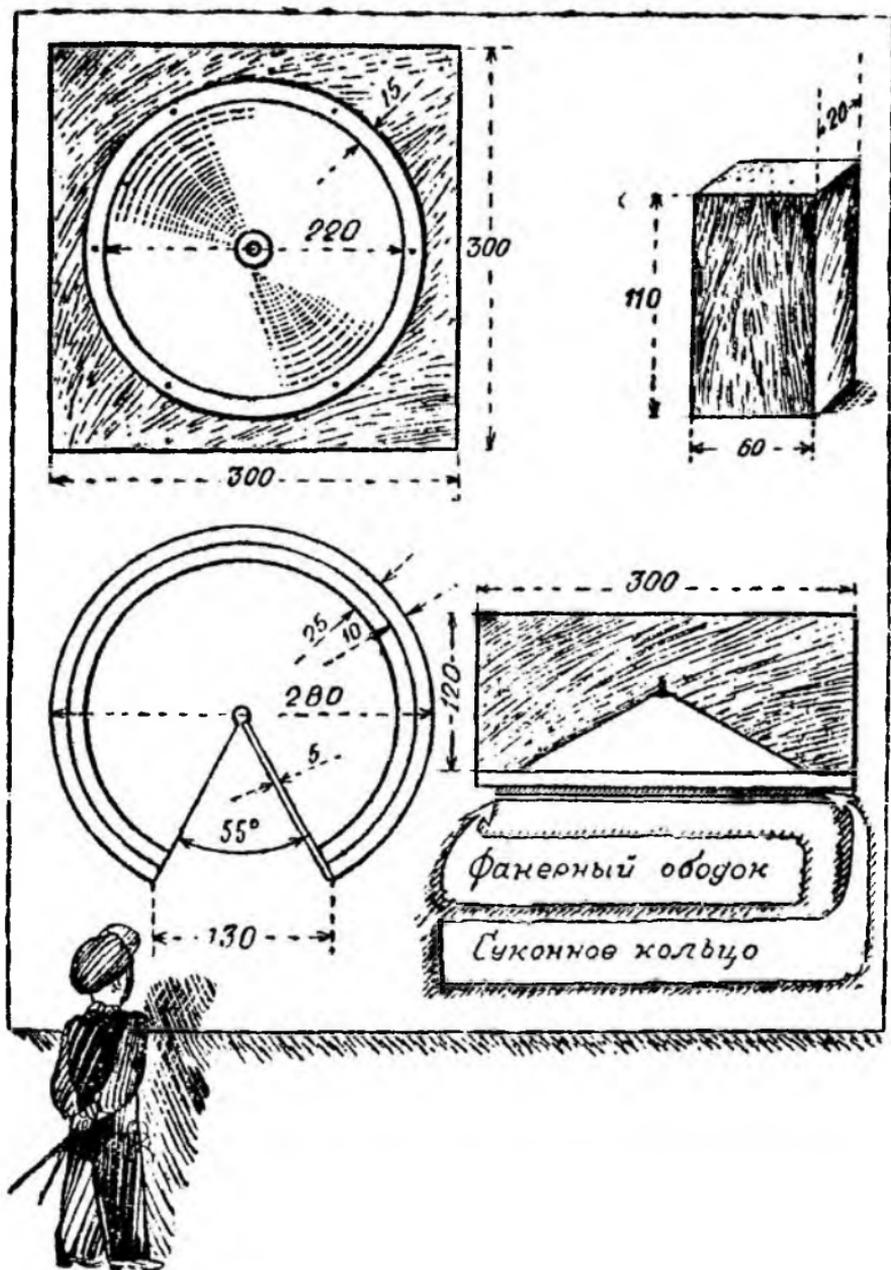
Рис. 48. Конусный диффузор.
