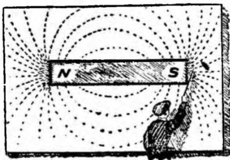
Рис. 15. Силовые линии магнита.
