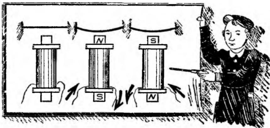
Рис. 13. Телефон без постоянного магнита работает неправильно.
