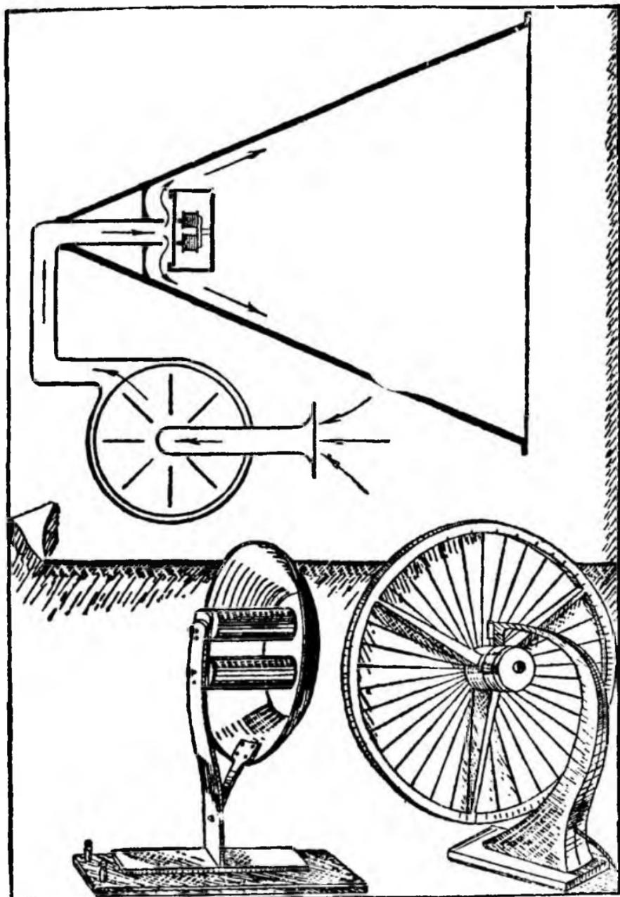
Рис. 60. Первые образцы громкоговорителей: пневматический громкоговоритель «Оксетофон» Парсонса; безрупорный громкоговоритель Грея с диффузором в виде железной сковородки (1879 г.); первый громкоговоритель с бумажным диффузором системы Люмьера (1909 г.).
