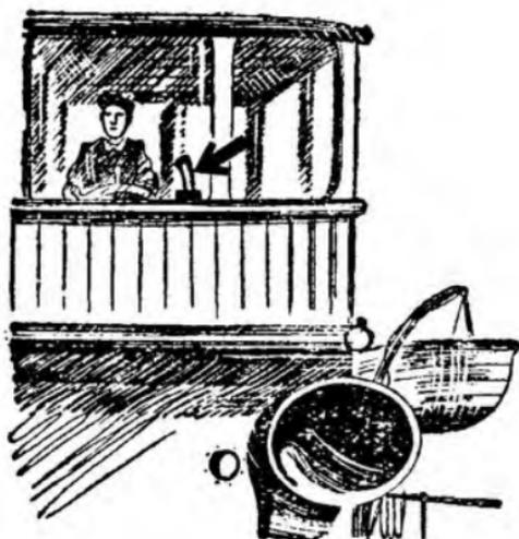
Рис. 1. Переговорная трубка на корабле.
