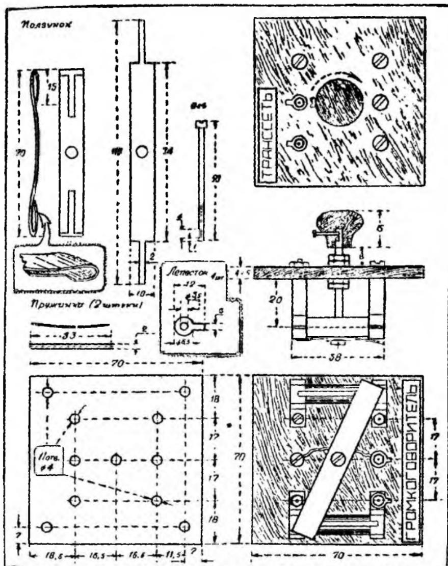
Рис. 59. Регулятор громкости и его детали.
