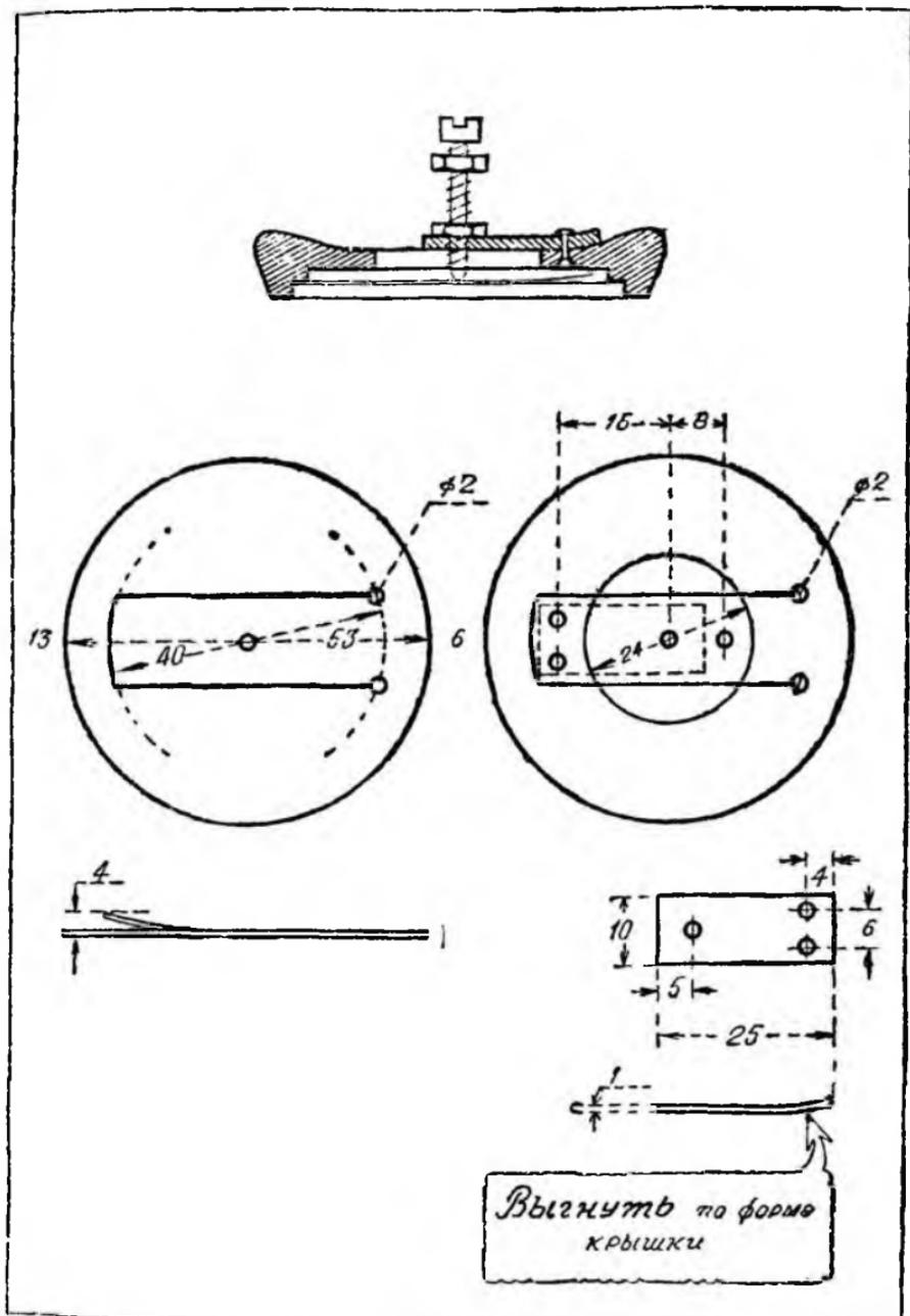
Рис. 27. Детали громкоговорителя из телефонной трубки с язычком.
