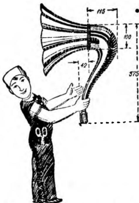
Рис. 21. Размеры изогнутого рупора.
