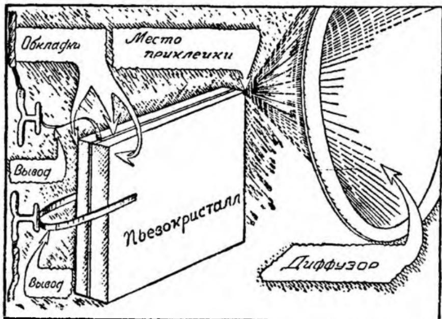
Рис. 63. Устройство пьезоэлектрического громкоговорителя.
