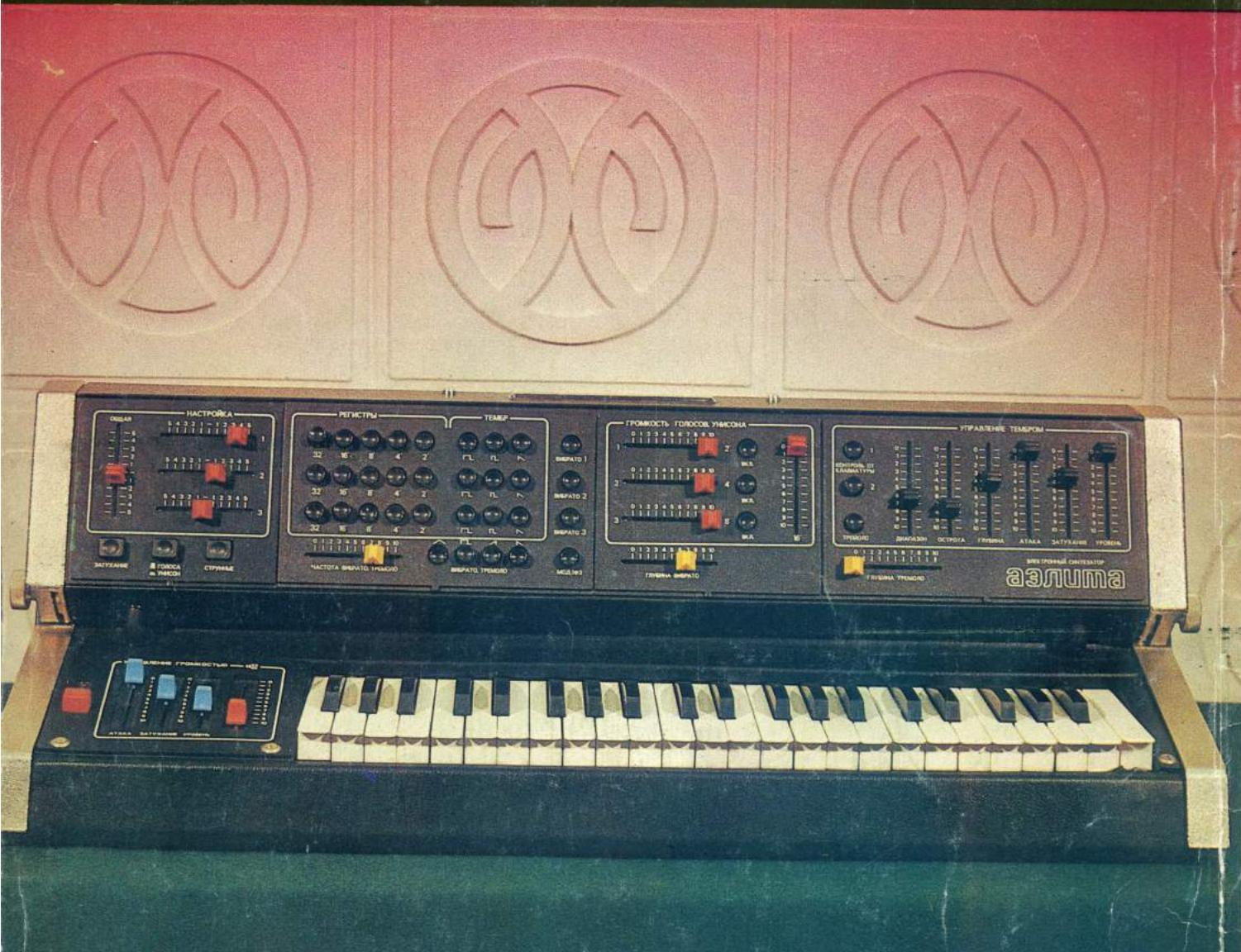
«АЭЛИТА» позволяет во время исполнения менять характер звучания, используя эффекты: трехголосный унисон, тембровое глиссандо, частотное вибрато, тембровое tremolo, затухание, атаку, strinGs (струнные).
