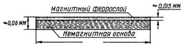
Рис. 1. Схематический разрез двухслойной магнитофонной ленты
