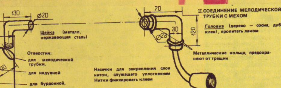
Насечки для закрепления слоя ниток, служащего уплотнением
